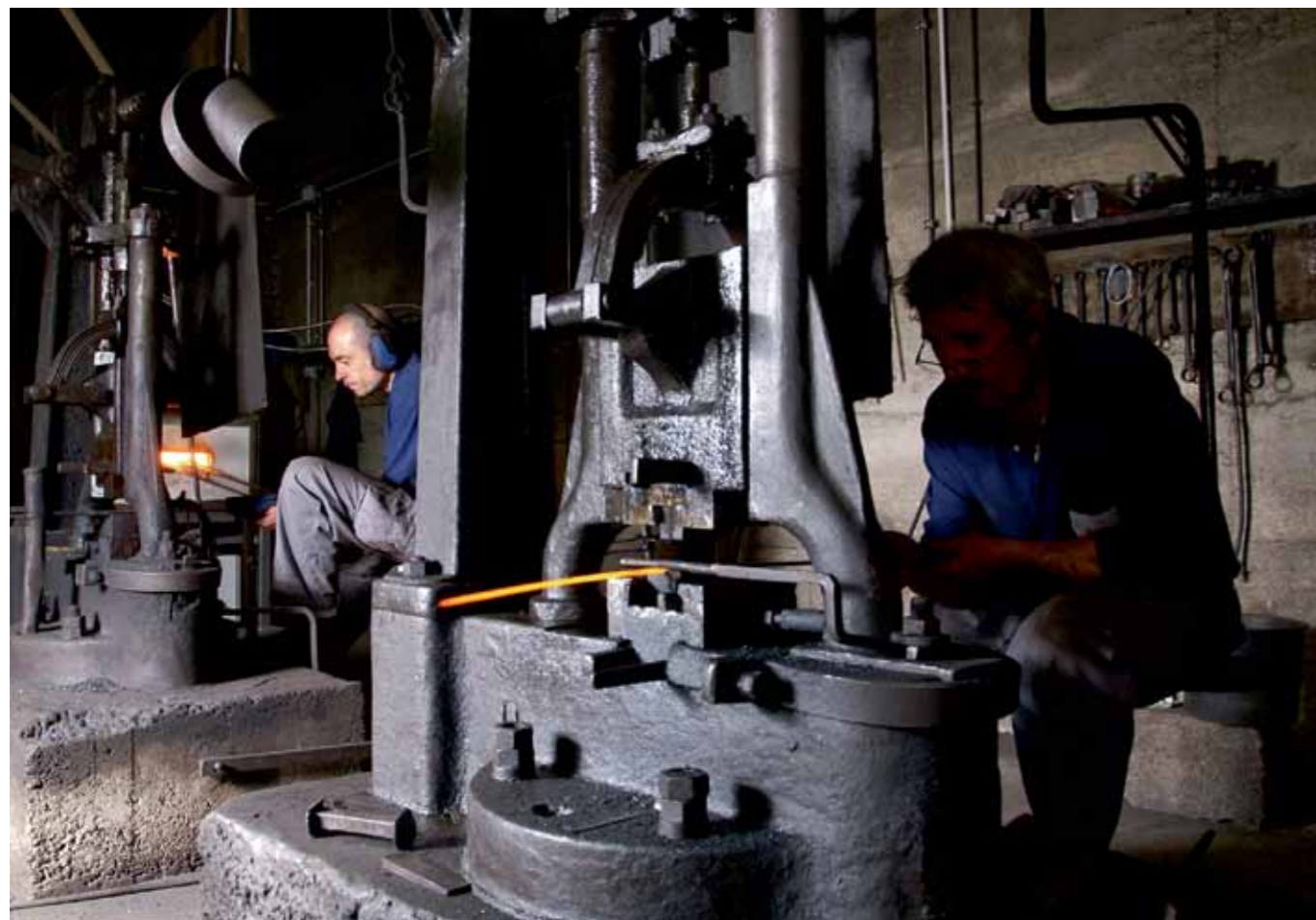
Placées une à une sous les coups de butoir des marteaux-pilons, les lames, au stade de la maquette, commencent à prendre forme.
