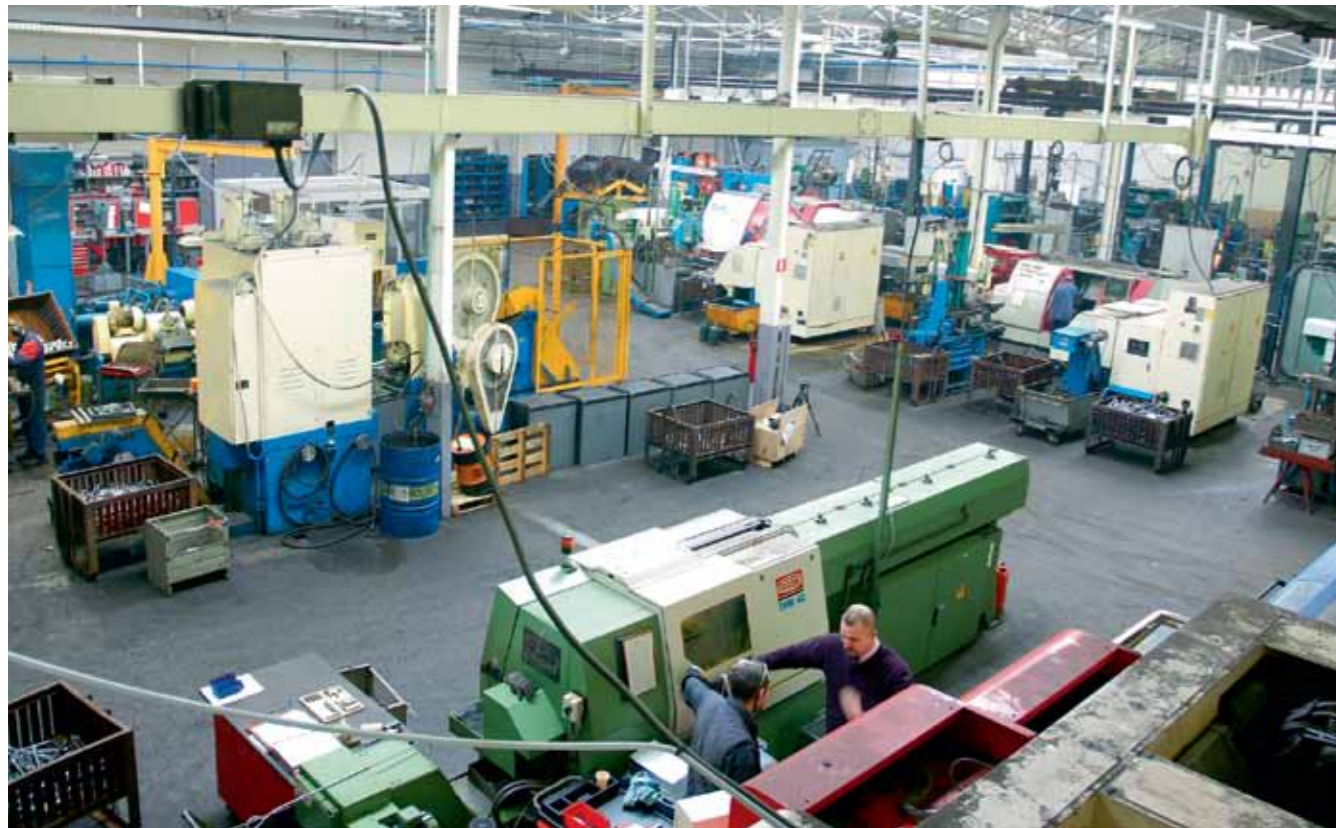
Le bâtiment d'usinage. Sur 5 hectares, SAM outillage possède 20 000 m 2 de surface au sol couverte. En deux ans, l'entreprise a réorganisé tout le site en offrant à chacune des étapes de fabrication (forge, usinage, traitement thermique, logistique) un bâtiment dédié.
