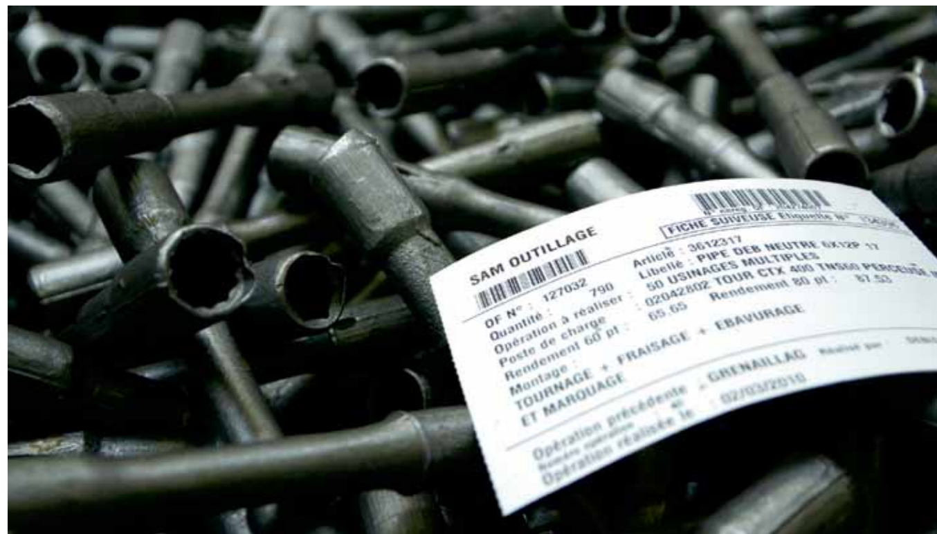
Des clés à pipe brutes de forges, en attente d'usinage. 30 % de la gamme est entièrement fabriquée à Saint-Étienne, et 80 % y subit au moins une opération.
