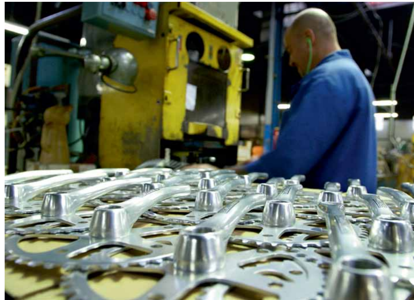
Tous les plateaux, de l'entrée au haut de gamme, sont contrôlés un à un, et testés avec une machine qui en corrige la voilure.
