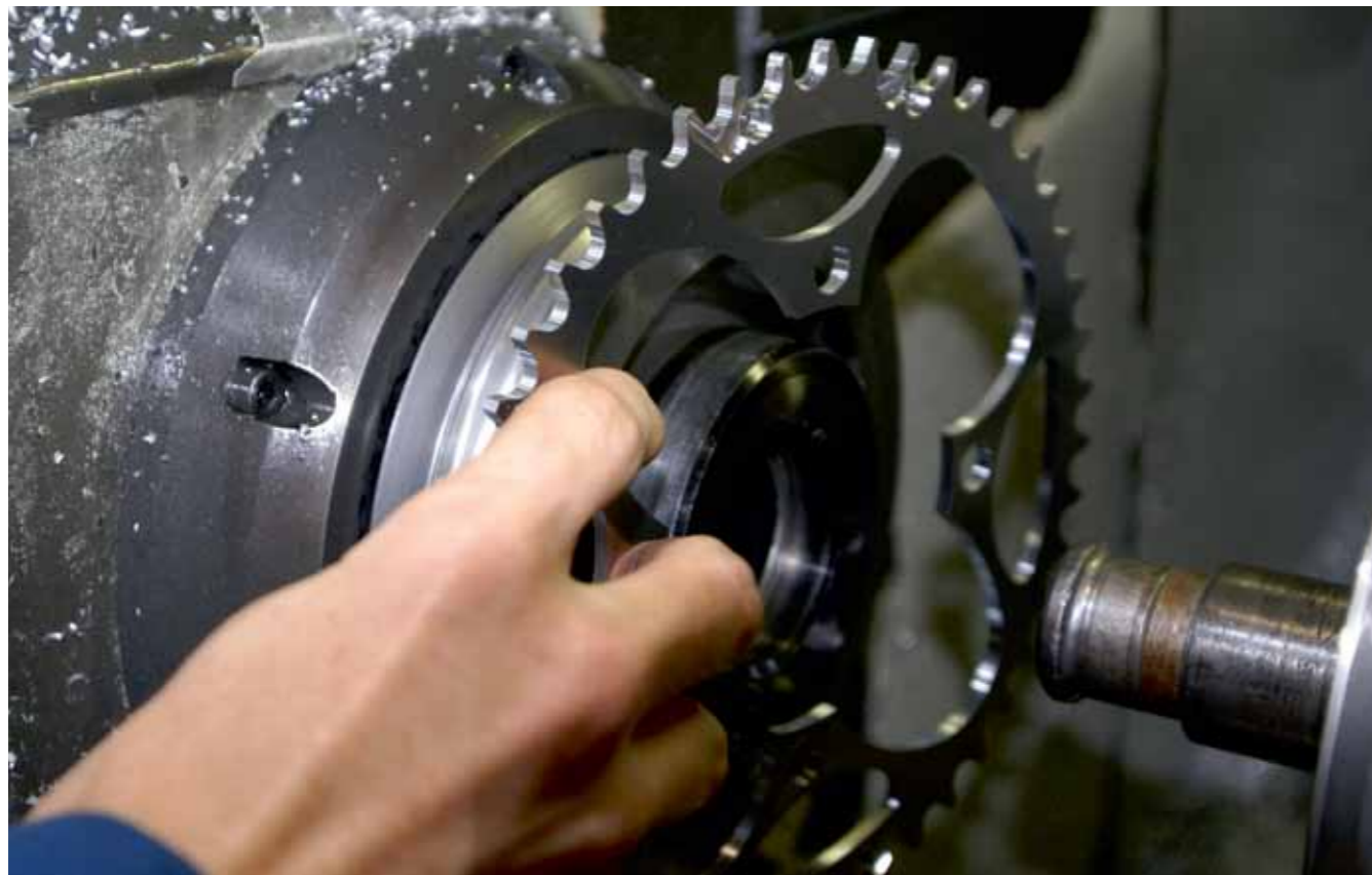
Les plateaux d'entrée de gamme, en aluminium 5083, sont découpés à la presse. Les autres sont usinés sur des machines développées en interne.
